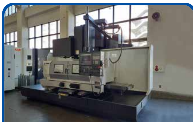
#50立形マシニングセンタ(オークマ) 2016年 MILLAC761VII 電源 OSP-P300M 1900万円 税込2090万円 (足立)
