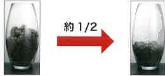
SGLB 41 × 1.3mm SMARTCUT BAND 41 × 0.9mm SUS304 φ 200 での切粉の容積比較
