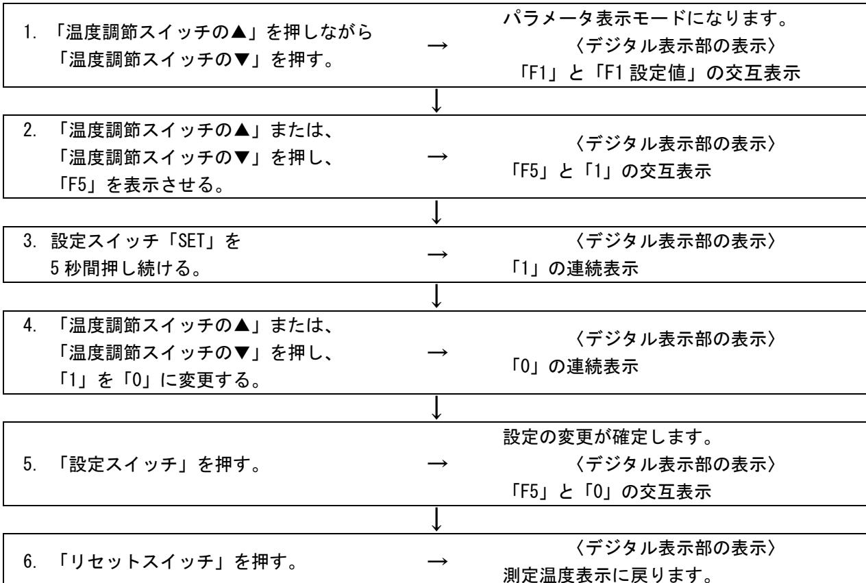
※他のパラメータの変更も、2. で表示させ、3. 以降の操作で変更できます。
