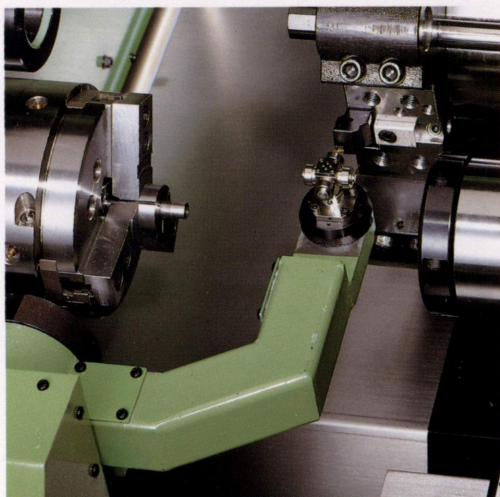
内段取り作業を大幅に効率化するともに、安全性の面でも有利な機内ツールプリセッタ(オプション)。
