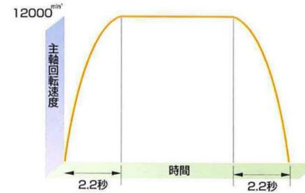
主軸最大回転速度の高速化に加えて、主軸立ち上がり時間の高速化が生産性を高めています。
