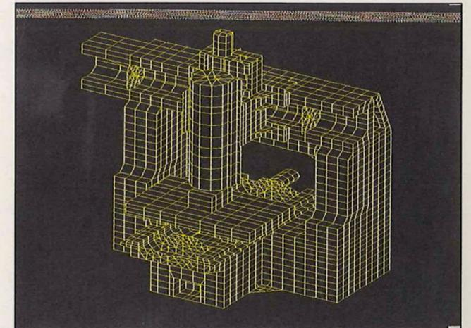
FJVシリーズは門形コラム構造を採用し、FEM解析を活用して設計されています。FEM解析とはコンピュータによって有限要素法による構造解析をおこなう手法で、この解析方法を利用してシミュレーションを行い、外力による各部の変位量を求め、高速運動に耐える高い剛性の構造設計を行いました。
