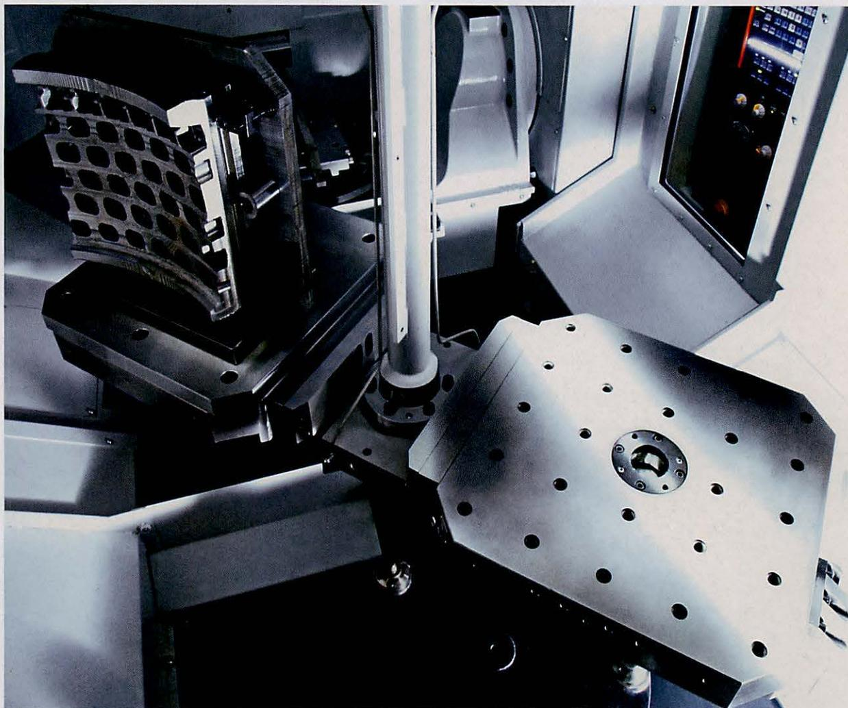
ロード、アンロードステーション上のパレットは、90°毎、4ポジションに割出しができることからワークの取付取外し、取付け具段取りを容易にしています。(写真は2パレットチェンジャドアを除いてあります。)
