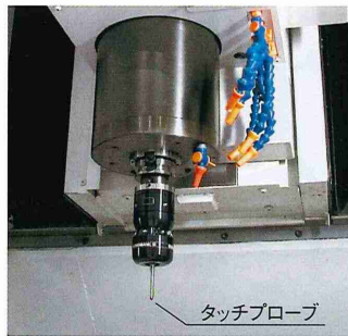
自動原点補正・自動計測 (オプティカル信号伝達式タッチプローブ)
