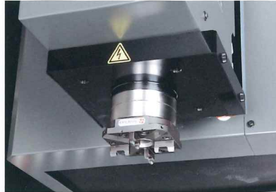
主軸側ホルダーをエアチャックでクランプ (写真はEROWA ITS50チャック仕様です)
