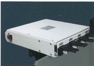
電極4本までの交換が可能 複数電極を使用した連続加工に対応
