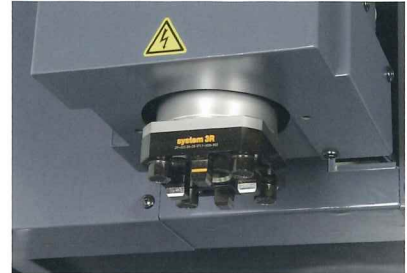
電極平行出し及び割出し加工に対応 主軸中心より液噴出に対応(写真は3R MACROチャック仕様です)
