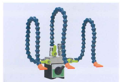
3分割された加工液を加工部に噴射
