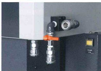
ピッチ加工時に極間に加工液を噴射
