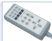
液晶表示付で作業性が向上 ワーク座標の設定が手元操作箱より可能 オーバーライド機能でジョグ送り速度を50~150%変更可能
