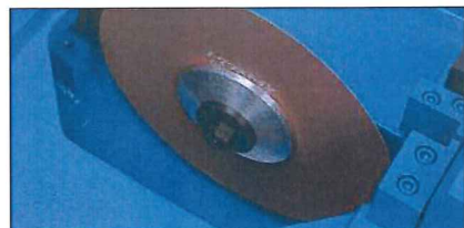
トイシ交換用スペース
