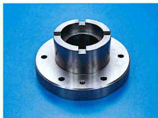
材質 : FC25 ワークサイズ : φ175×85mm 加工時間 : 15分 加工ポイント : 中物部品の複合加工 加工機 : LB45 \pi -M
