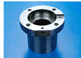
材質 : FC20 ワークサイズ : φ155×120mm 加工時間 : 12分 加工ポイント : X-C軸による創成加工 加工機 : LB35 \pi -M
