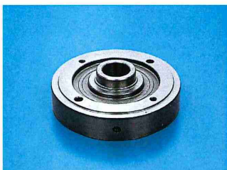
材質 : FC25 ワークサイズ : φ165×50mm 加工時間 : 3.5分 加工ポイント : 端面、側面穴を含む全加工 加工機 : LB45 \pi -M
