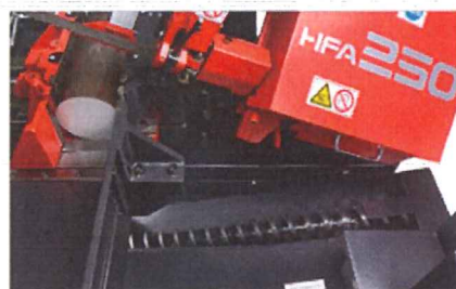
チップコンベヤー
