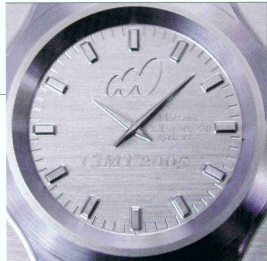
R0.2超硬エンドミルによる1 \mu m幅の文字加工
