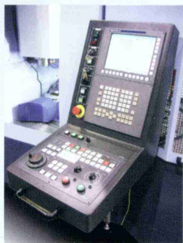
LX-0には、最新鋭高性能NCシステム Matsuura L-Tech 30i を搭載。
