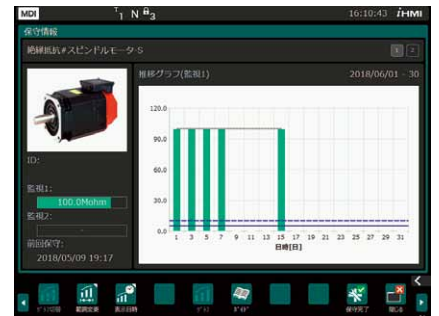
絶縁劣化検出機能画面
