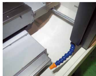
機内洗浄付きクーラント装置（オイルガン付き）
