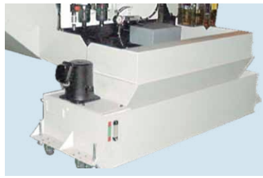
クーラント装置（タンク部）
