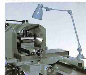
● 作業用照明灯
