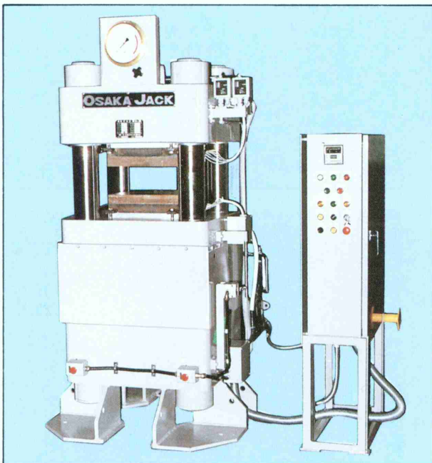
写-29 熱板付500Ton 4 柱式プレス
