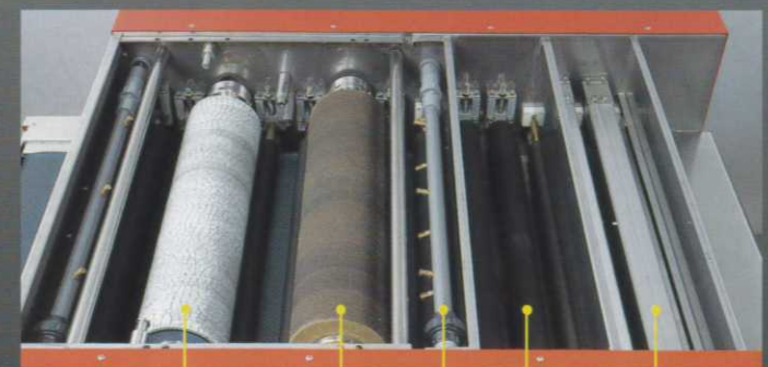
乾燥ブロー送風部ファン・送風ノズル。エアナイフに強力送風
