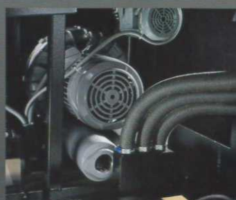
乾燥ブロー送風部ファン・送風ノズル。エアナイフに強力送風
