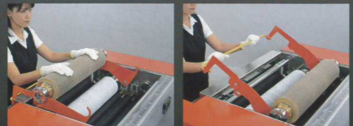
専用治具でNo.2ホイール(仕上げ用)を簡単に交換
