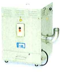
吸塵装置 幅×奥行×高さ (450×450×650) 使用モータ 0.4kW 風量 50Hz 150L/sec, 60Hz 180L/sec 静圧 50Hz 170mmAg, 60Hz 250mmAg Dust collector
