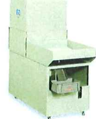
吸塵給水装置 (マグネットセパレータ付) 幅×奥行×高さ (540×1300×1300) 使用モータ 40W (給水用) 0.4kW (吸塵用) 25W (セパレータ用) 吸塵能力 50/60Hz, 9.0/10.8 1 /min ポンプ能力 50/60Hz, 19/25 1 /min マグネットセパレータ能力 20/40L/min タンク容量 100L Dust collector/Coolant device with magnetic separator
