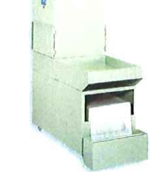
吸塵給水装置 (手動ペーパーフィルタ付) 幅×奥行×高さ (540×1300×1300) 使用モータ 40W (給水用) 0.4kW (吸塵用) ペーパーサイズ 370mm×50m 吸塵能力 50/60Hz, 9.0/10.8 1 /min ポンプ能力 50/60Hz, 19/25 1 /min タンク容量 100L Dust collector/Coolant device with manual paper filter winder
