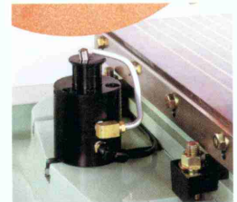
固定ドレストタイプ チャック上面より最大高さ50mmまで 調整可能です。 Fixed dressing device Height is adjustable to 50mm higher than top of magnetic chuck
